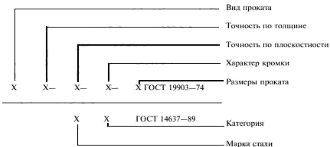
**П р и м е ч а н и е .** Параметры и характеристики проката, приведенные в схеме, если они не указаны в заказе, устанавливаются изготовителем и в обозначении не приводятся.
