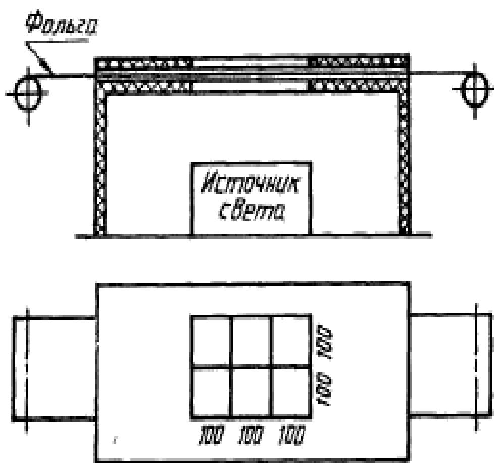
Прибор изготавливается в форме ящика, внутри которого предусматривается достаточное освещение. В верхней части ящика вырезают отверстие прямоугольной формы, в которое устанавливают сетку с клеткамиплощадью 1 дм<sup>2</sup>.
